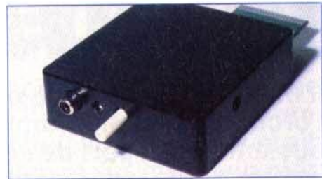
Le Vidi ST pour Atari contient une mémoire capable de saisir au vol une image vidéo sur deux. Une version plus lente est disponible pour l'Amiga et les compatibles PC.
